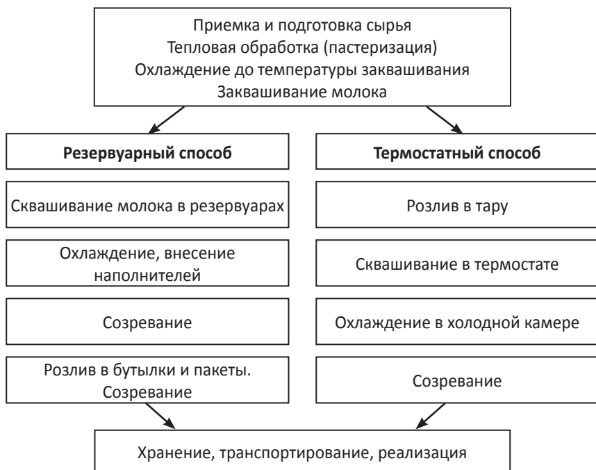
Рис. 4. Технологическая схема производства кисломолочных продуктов резервуарным и термостатным способами
