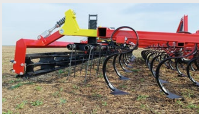
Рабочие органы – стрельчатые лапы на S-образных пружинных стойках, 2-рядные пружинные боронки, катки
