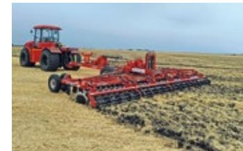
В агрегате с трактором T-360 на измельч. пожнивн. остатков подсолнечника
